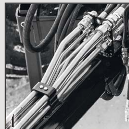
Внешние стальные гидрролинии
