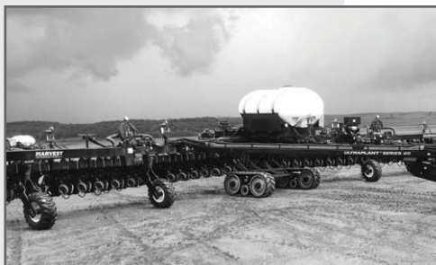
Сеялка PB6020-ULTRAFLEX с гусеницами и баком для ЖКУ на 3800 литра
