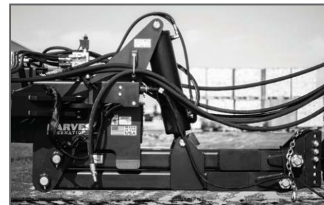
Сверхмощное сцепное устройство с самовыравнивающимся гидравлическим дышлом
