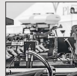
Крепления для модуля PDM, турбин, гидрораспр. и тд. на раме
